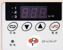
1メニューにつき最大9ステップまでのプログラムが登録可能で、強火炊き、弱火炊き、蒸らしの各工程を自由に組み合わせてそれぞれに調理時間を設定できます。たとえば炊き上がり直前に強火炊きを行うおこげを作るなど、ボタンひとつで簡単にこだわりの釜めしが可能です。初期設定では①強火炊き3分、②弱火炊き9分30秒、③強火30秒となっています。
