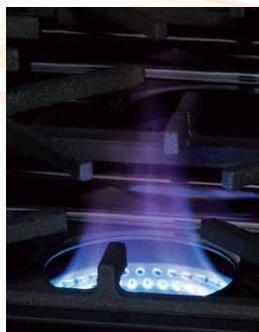
3.0kW(2,600kcal/h)の内部炎口方式のバーナーを採用。鍋底中心部を集中して加熱するため、親子鍋などの小さい鍋でもしっかりと加熱できます。
